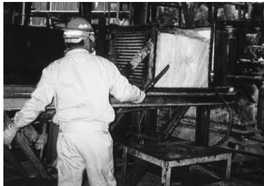
グラスウールのリサイクル(工場での溶解)
